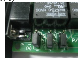
Фиг. 6 Настройка джемпера для закрытого контакта (А.С)
