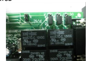
Фиг. 5 Обозначения закрытых (А.С) и открытых (А.О) контактов
