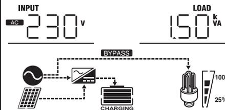
Входное напряжение/Нагрузка в Вт
