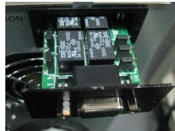
**Шаг 3:** верхняя панель AS400 должна плотно прилегать к задней панели ИБП. Прикрутите карту к корпусу двумя винтами.
