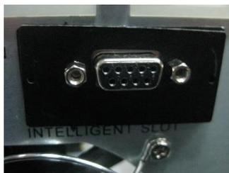
**Шаг 4:** используйте 9-контактный коммуникационный кабель, чтобы подключить ИБП и оборудование для удаленного мониторинга и управления.
